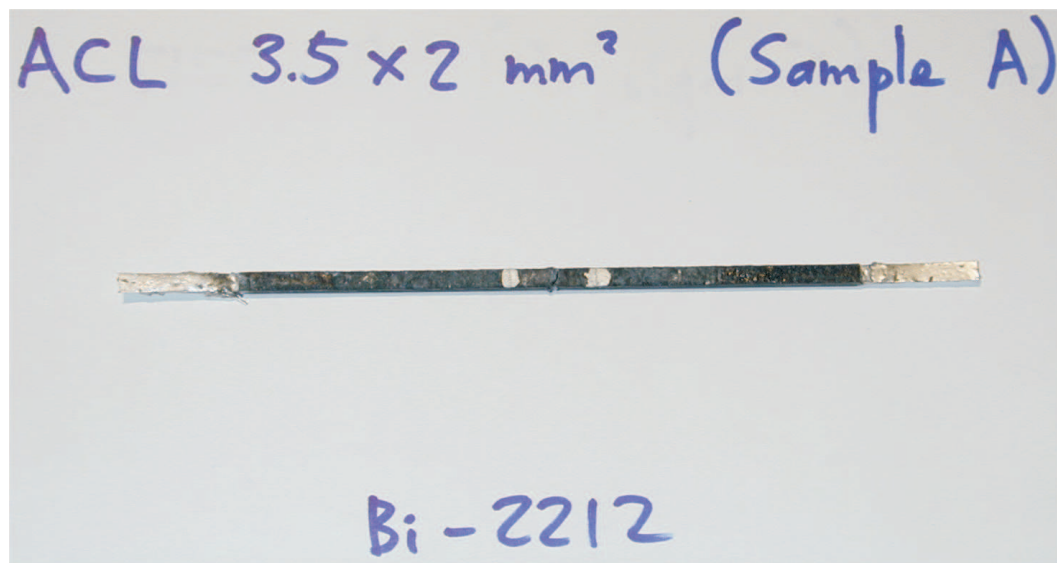
FIG. 9.3 – Photo d'un échantillon d'ACL (3.5 mm par 2 mm). Les dimensions exactes de l'échantillon sont de 3.47 mm par 2.05 mm, et les contacts de voltage sont séparés de 15.05 mm. La résistivité à l'état normal ( \rho_n ) de ce type de matériau est de l'ordre de 1500 à 1700 \mu\Omega .cm, ce qui est assez élevé.
