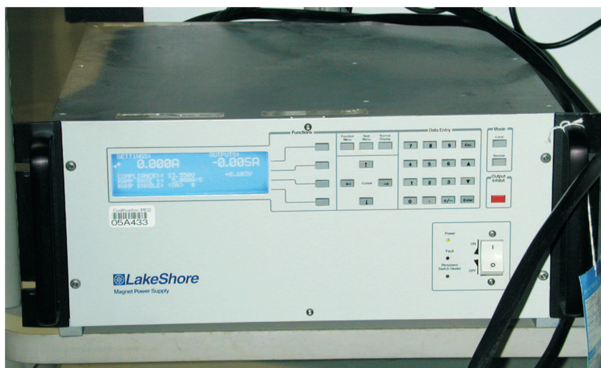
FIG. IV.3 – Photographie du LakeShore 622 « Magnet Power Supply ». Le LakeShore 622 donne un courant de sortie cc de 0 à 100 A, mais la puissance de sortie est limitée à 1000 W. Il est possible de brancher une sonde de Hall à l'appareil pour asservir la sortie à un niveau donné de densité de flux. Il s'agit d'un appareil construit pour alimenter des charges inductives, et sa sortie en courant est très régulière (moins de 0.1 % d'oscillations).
