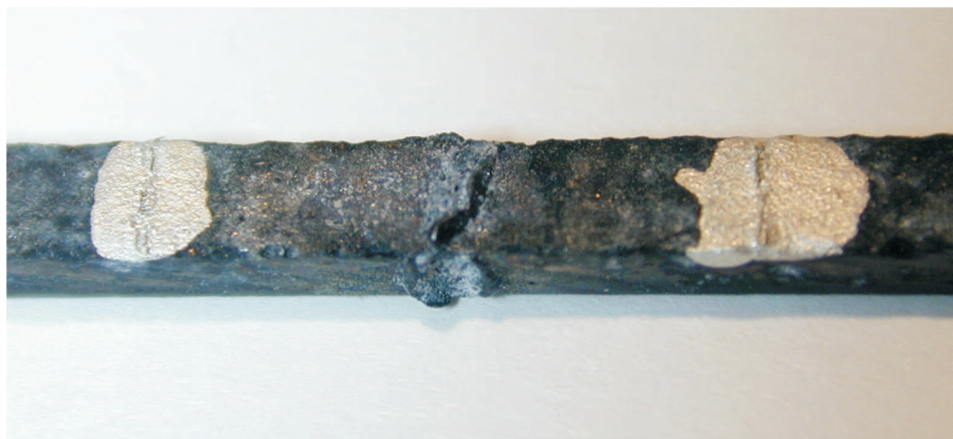
FIG. 9.4 – Grossissement de la partie centrale d'un échantillon d'ACL (3.5 mm par 2 mm). On voit la rupture au centre des deux taches de peinture d'argent, qui ont servi de contacts de tension.
